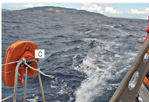
Un salvagente per l'uomo a mare. Come quello finito in acqua durante la rollata. C è la lunga cima da allungare appresso al salvagente, quando viene buttato in mare.
