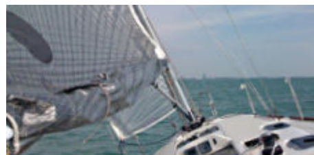
Esempio di barca con velatura ridotta. A prua una trinchetta. La randa abbassata e legata al boma (terzarolata), in primo piano
